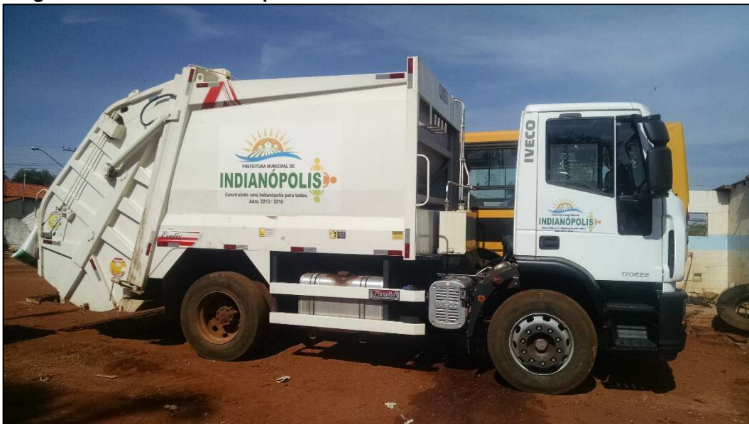
Figura 10.1. Caminhão compactador utilizado na coleta de resíduos domiciliares.
