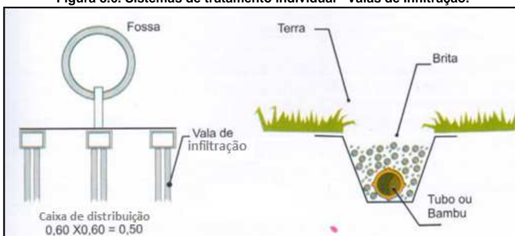
Figura 8.6. Sistemas de tratamento individual– Valas de Infiltração.
