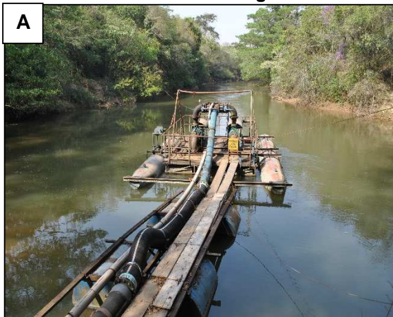
Figura 7.6. Balsa de captação superficial.
