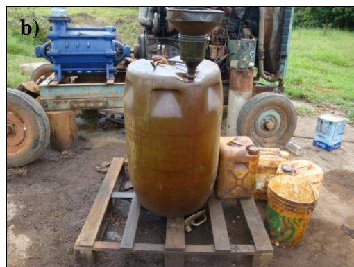
Figura 260 – a) Sistema de irrigação, sendo conjunto moto-bomba movido a óleo diesel ao ar livre, sem nenhum controle do vazamento de graxas e óleos, b) detalhe da bombona de 200 litros utilizada como tanque de combustível. Notam-se manchas ao solo de derramamentos de óleo diesel, graxa e óleos lubrificantes.
