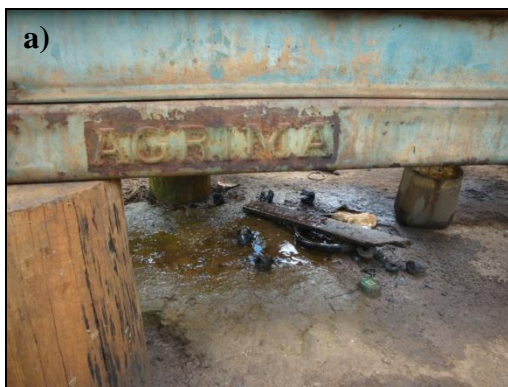
Figura 261 – a) Detalhe de vazamento de combustível abaixo do motor, b) detalhe da tubulação de recalque do conjunto. Foi realizada escavação no leito do Córrego para facilitar a captação da água.
