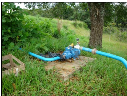
Figura 103 – a) e b) Mostram o conjunto moto-bomba destinados à irrigação de pastagem. Fonte: Raiz Ambiental Ltda.
