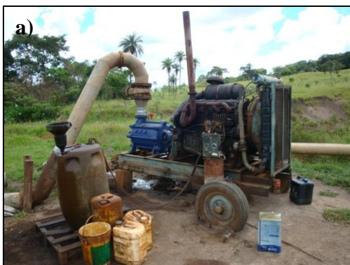
Figura 260 – a) Sistema de irrigação, sendo conjunto moto-bomba movido a óleo diesel ao ar livre, sem nenhum controle do vazamento de graxas e óleos, b) detalhe da bombona de 200 litros utilizada como tanque de combustível. Notam-se manchas ao solo de derramamentos de óleo diesel, graxa e óleos lubrificantes.
