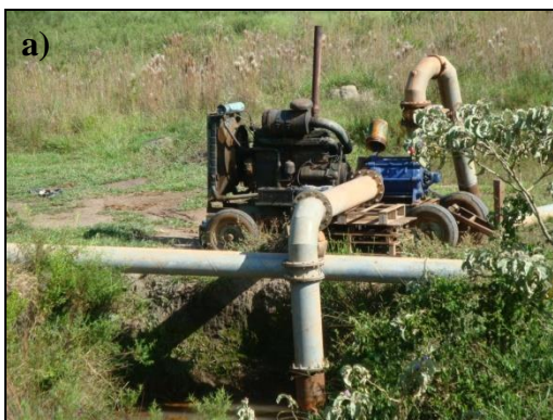
Figura 258 – a) e b) Vista de local de captação de água no interior da propriedade. Observa-se o uso irregular de moto-bomba a diesel ao lado do leito do Córrego Capão da Erva, com riscos de contaminação do manancial.
