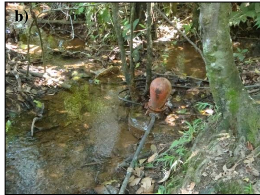
Figura 242 – a) Vista do interior da mata (APP) onde se localiza uma surgência. Nota-se a “picada” aberta no meio da mata para dar acesso ao ponto de captação, b) vista de equipamento (carneiro mecânico) para emissão de água à residência. Fonte: Raiz Ambiental Ltda.
